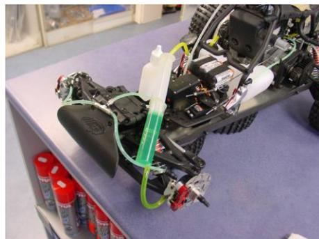
Nach verschließen der Entlüftungsventile mehrmals mit dem Bremshebel die Bremse von Hand betätigen und auf etwaige Luftblasen in den Bremsleitungen achten. Sollten sich Luftblasen in den Bremsleitungen befinden den Entlüftungsvorgang solange wiederholen bis keine Luftblasen mehr in den Bremsleitungen sind.
